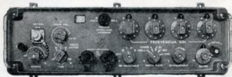
Sl. 5 — Prednja ploča primopredajnika PD-8
